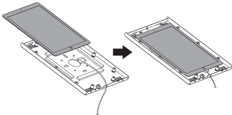
Far passare il cavo di alimentazione passando dal foro posteriore o lateralmente a seconda delle esigenze.
