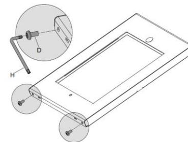
Infine inserire le 2 viti Torx con la chiave in dotazione per chiudere il contenitore.
