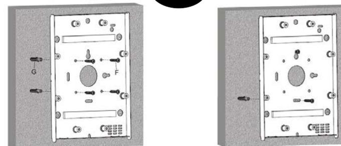
Fissare il retro del contenitore a parete o su staffe in funzione delle esigenze, usando le viti in dotazione.
